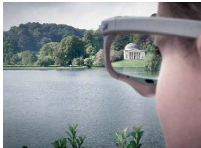
An den unteren Rändern der beiden Glasfassungen befinden sich kleine Infrarot-Kameras. Sie registrieren die Pupillentätigkeit, also die Augenbewegungen.
