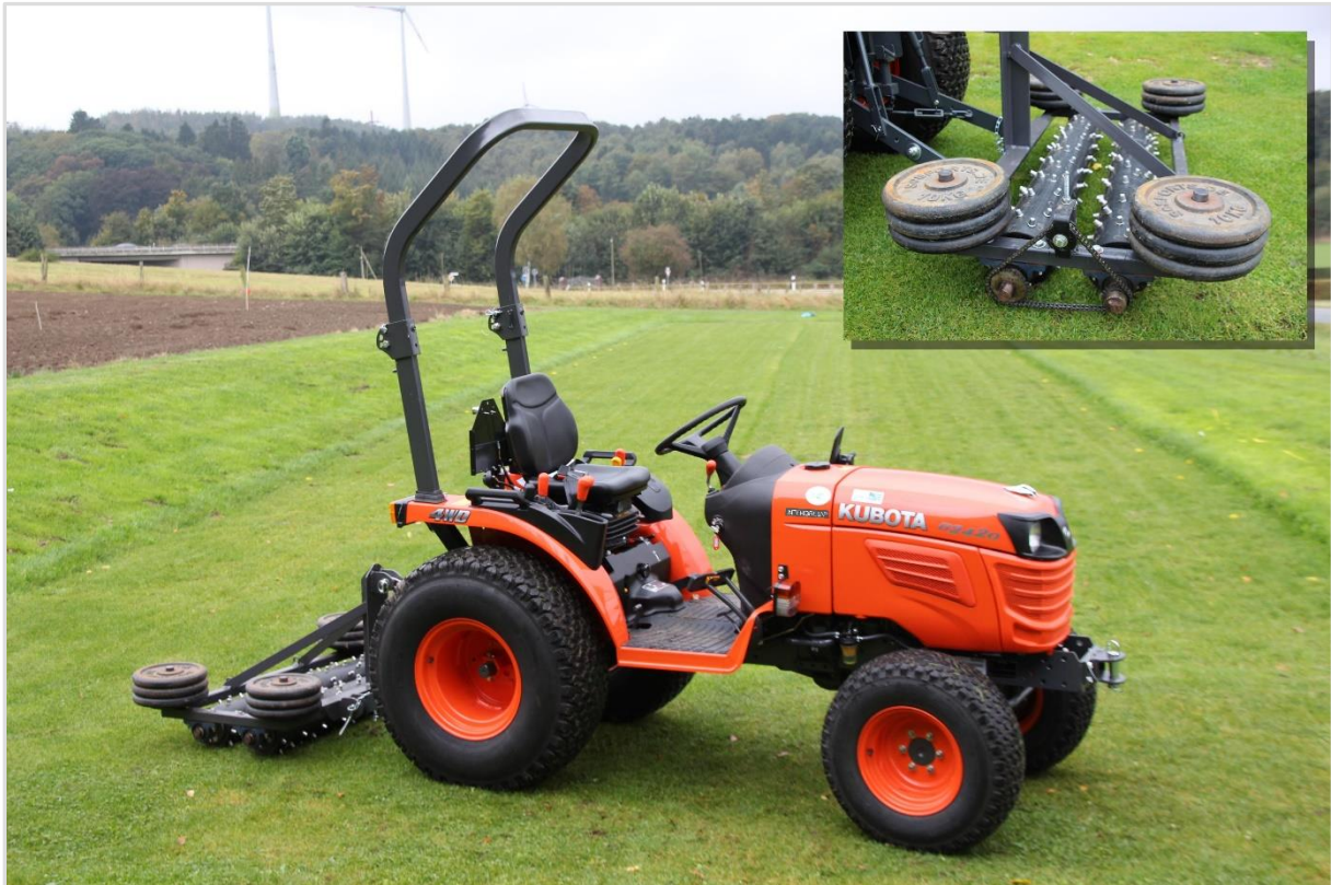
Abb. 2: Kompakttraktor mit Stollenwalze; kleines Bild: Detail Stollenwalze (FLACHMANN, 2016)
