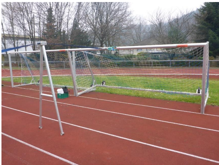
Abb. 1: Dieses Tor hebt sich bei der Zugprüfung nach DIN EN 748 an.
