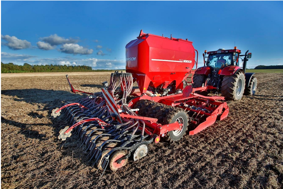
Abb. 2: Sämaschine mit Piezosensoren bei der Aussaat (Foto: HORSCH 2015)
