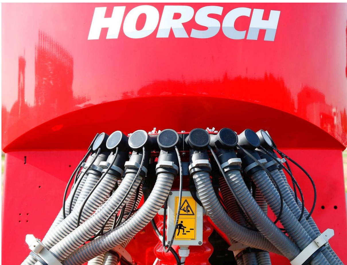
Abb. 1: Verteilturm einer pneumatischen Sämaschine mit Piezosensoren (Foto: HORSCH 2015)
