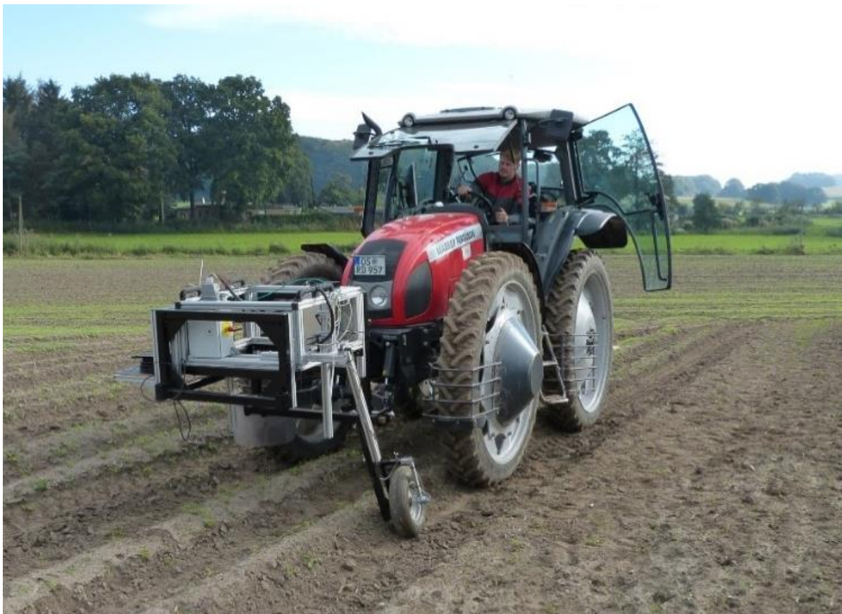
Abb. 1: Beikrautdetektion im Dreipunkt-Frontanbau des Traktors. (Foto: Frederik Langsenkamp)
