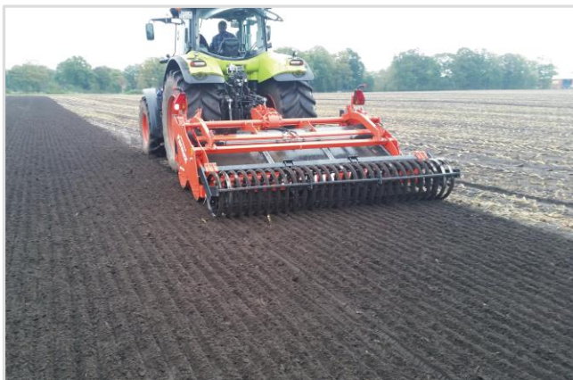
Abb. 1: Spatenmaschine Farmax LRP 300 Profi
