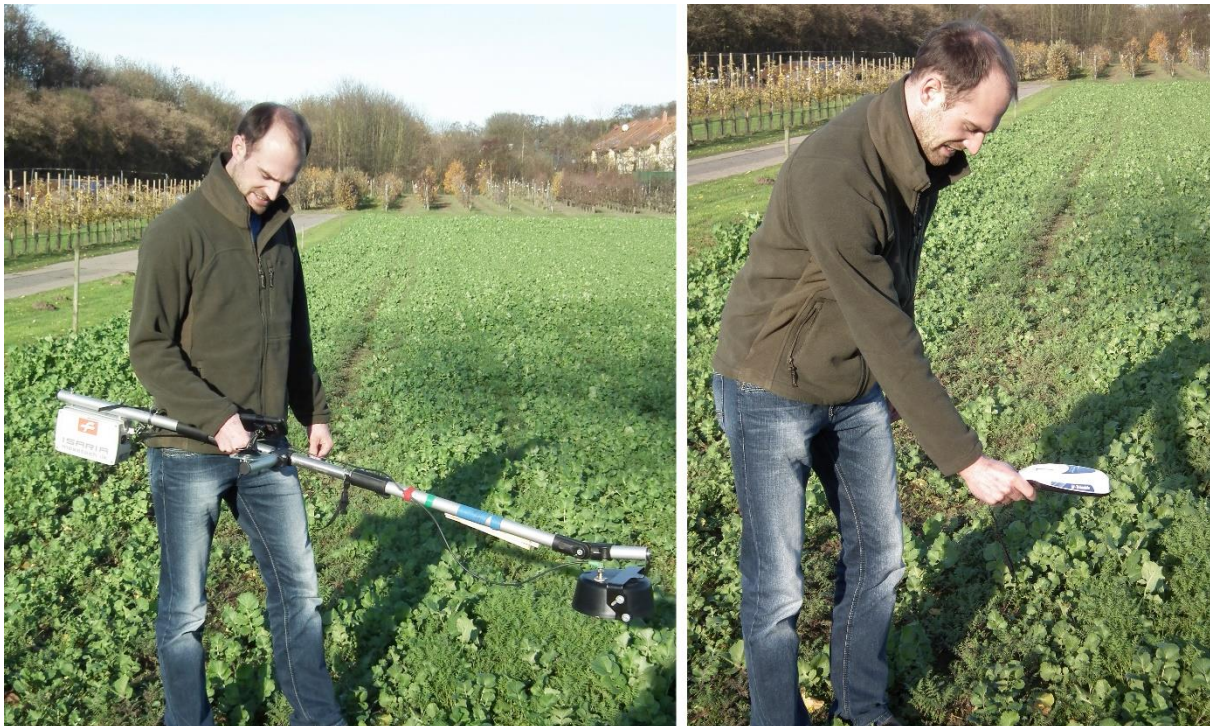
Abb. 1: Die Handsensoren Isaria (links) und GreenSeeker-Compact (der hier nicht dargestellte GreenSeeker ähnelt im Aufbau stark dem Isaria)
