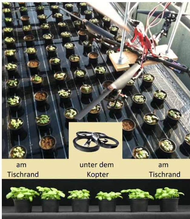
Abb. 1: Versuchsaufbau mit fest installiertem Koptermodell (oben) und durch Luftturbulenzen beeinflusste Pflanzenhöhen (unten)
