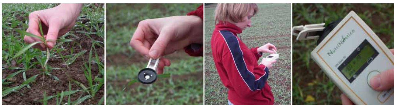
Abb. 1: Einsatz des Mangan-Schnelltesters NN-Easy 55 (von links: Entnahme von Pflanzen zur Messung - Befestigen des Messclips am Blatt - Aufsetzen des Messclips an die Messoptik des Mn-Schnelltesters - Durchführung der Messung und Ablesen des Mn-Versorgungszustands)
