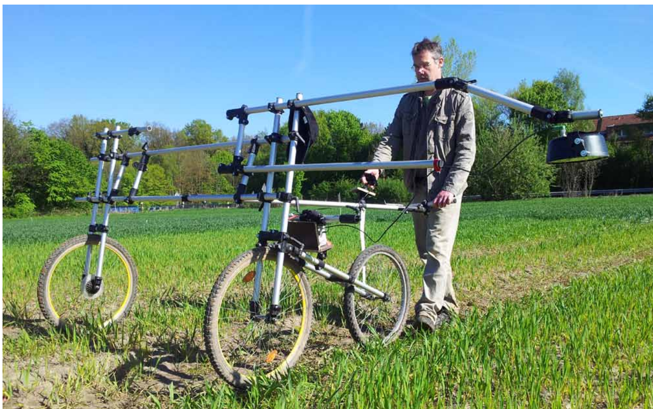
Abb. 1: Sensormessungen mit Messgestell in einem Weizenbestand (Bild: S. Reusch [Yara], 2014)
