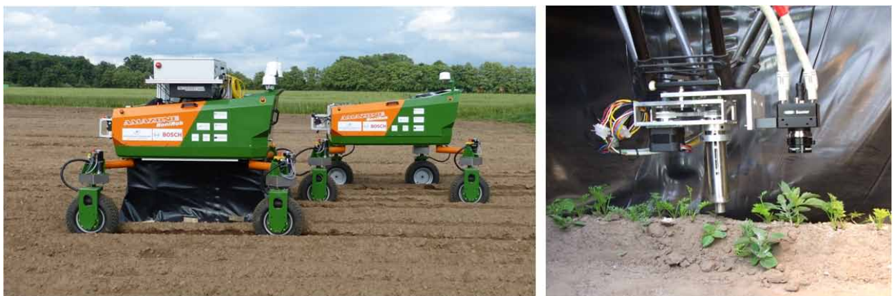
Abb. 2: Multifunktionale Roboterplattform BoniRob mit integriertem Beikrautregulierungssystem RemoteFarming.1 (links) und Aktor (Hülsenstempel) (rechts)
