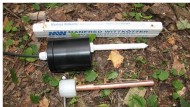
Abbildung 25: CO 2 -Sensor und Mini-Erdbohrer zum Vorbohren des Sonden-Einführlochs
