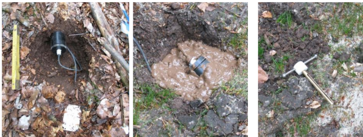
Abbildung 27 Phasen des Sensoreinbaus. li. nach Einführen in Sondenloch, mi. Einschlämmen, re. Einbau abgeschlossen. Der Bohrer deutet die Lage der Sonde an.
