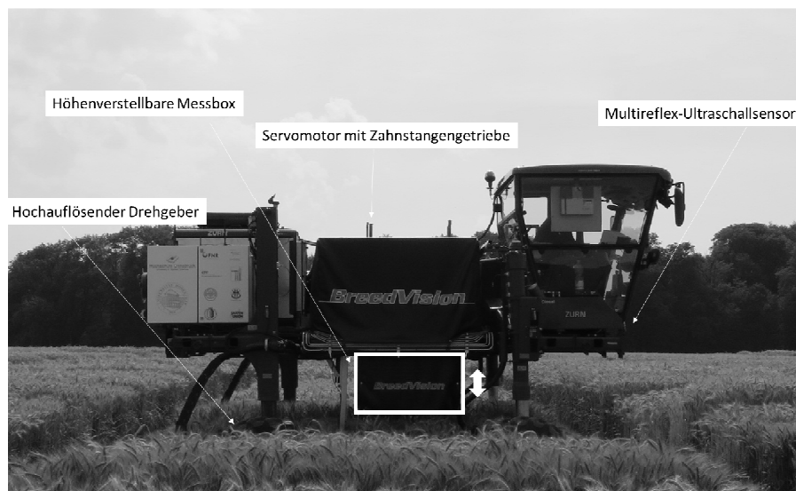
Abb. 1: Übersicht über die Einzelkomponenten der automatischen Höhennachführung in der Plattform
