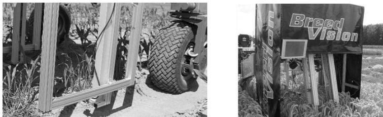
Abbildung 1: Integration des Lichtgitters in den Phänotypisierungsplattformen für Feldmessungen in Mais (BoniRob links) und in Triticale (BreedVision rechts)
