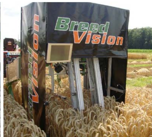
Bild 4: Feldmessungen mit bildgebenden Lichtgittern in Mais mit dem autonomen Feldroboter BoniRob (links) und der Phänotypisierungsplattform BreedVision in Triticale (rechts) nach BUSEMEYER et al. 2010 sowie dort aufgeführter Referenzen.
