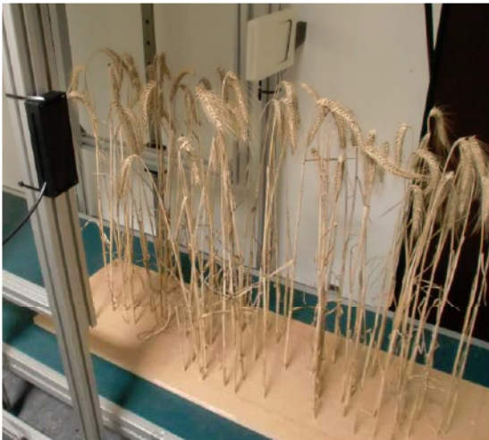
Bild 3: Dynamischer Messplatz (Förderband) zur Sensor- und Algorithmenentwicklung unter Laborbedingungen; Laserzeilensensor-Modul im Ährenbereich (links) und Lichtgitter über die gesamte Pflanzenhöhe (rechts)
