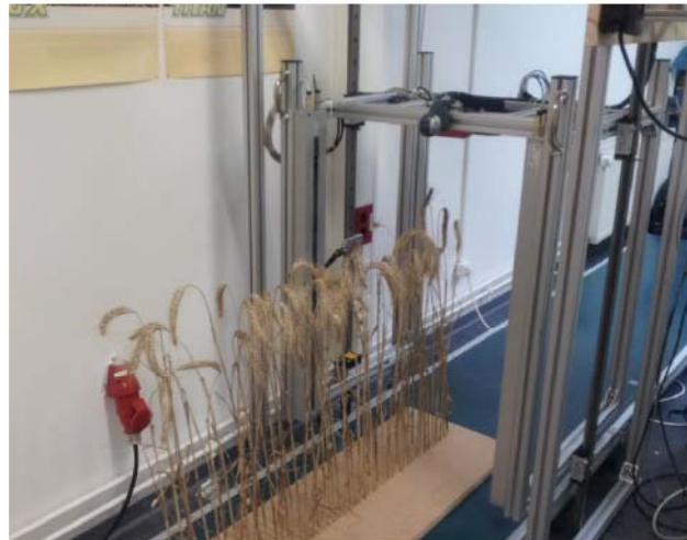
Bild 3: Dynamischer Messplatz (Förderband) zur Sensor- und Algorithmenentwicklung unter Laborbedingungen; Laserzeilensensor-Modul im Ährenbereich (links) und Lichtgitter über die gesamte Pflanzenhöhe (rechts)
