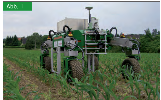
Der autonome Feldroboter BoniRob bei der Vermessung von Einzelpflanzen auf einem Maisfeld (Foto: Hochschule Osnabrück) Fig. 1: Measurements of individual plants on a maize field with the autonomous fieldrobot BoniRob
