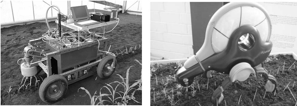
Abb. 2: Modul einer sensorgesteuerten Querhacke zur Unkrautregulierung innerhalb der Reihe (links); Designvorschlag zur Umsetzung als autonomer Unkrautroboter (Fotos: A. RUCKELSHAUSEN/M. MARDER)
