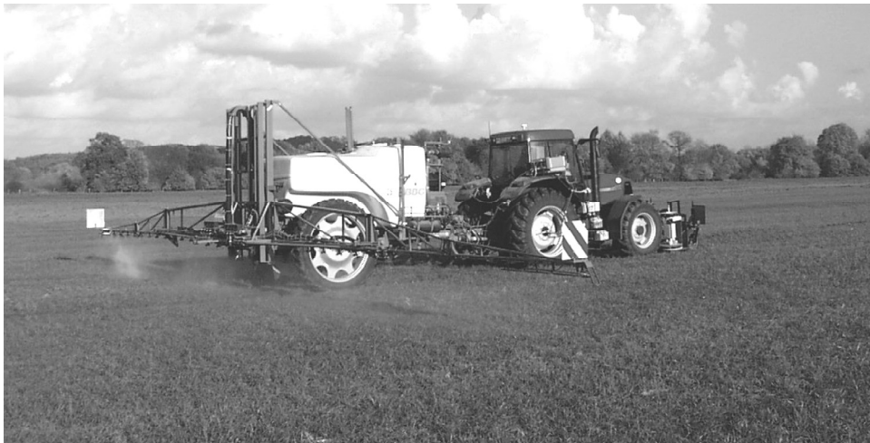
Bild 13: Traktor mit Anhängfeldspritze und Unkrautsensor
