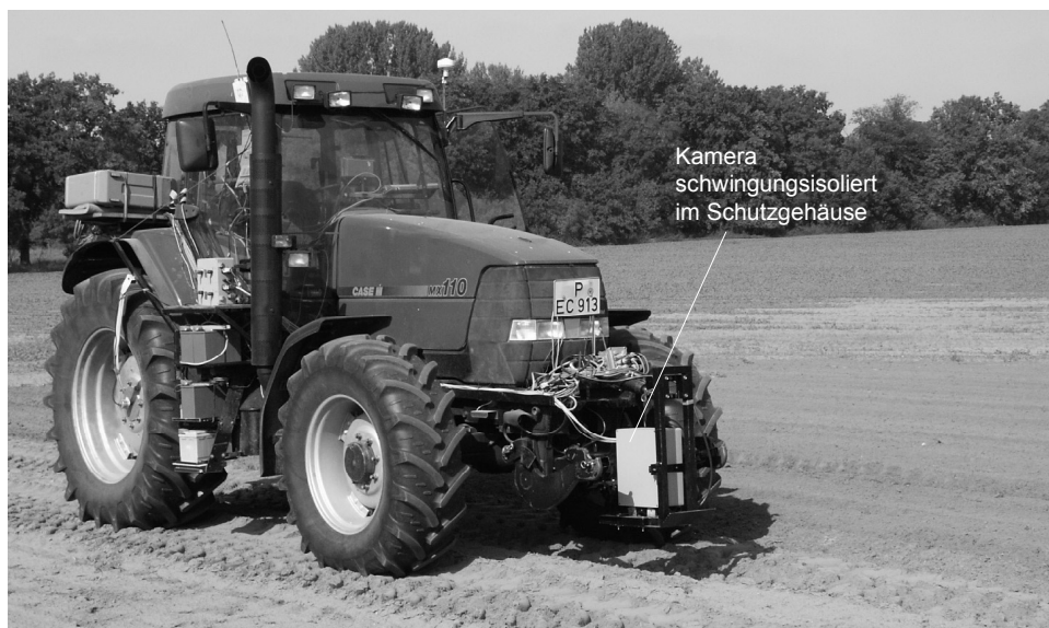
Bild 61: Versuchstraktor mit Kamerasystem
