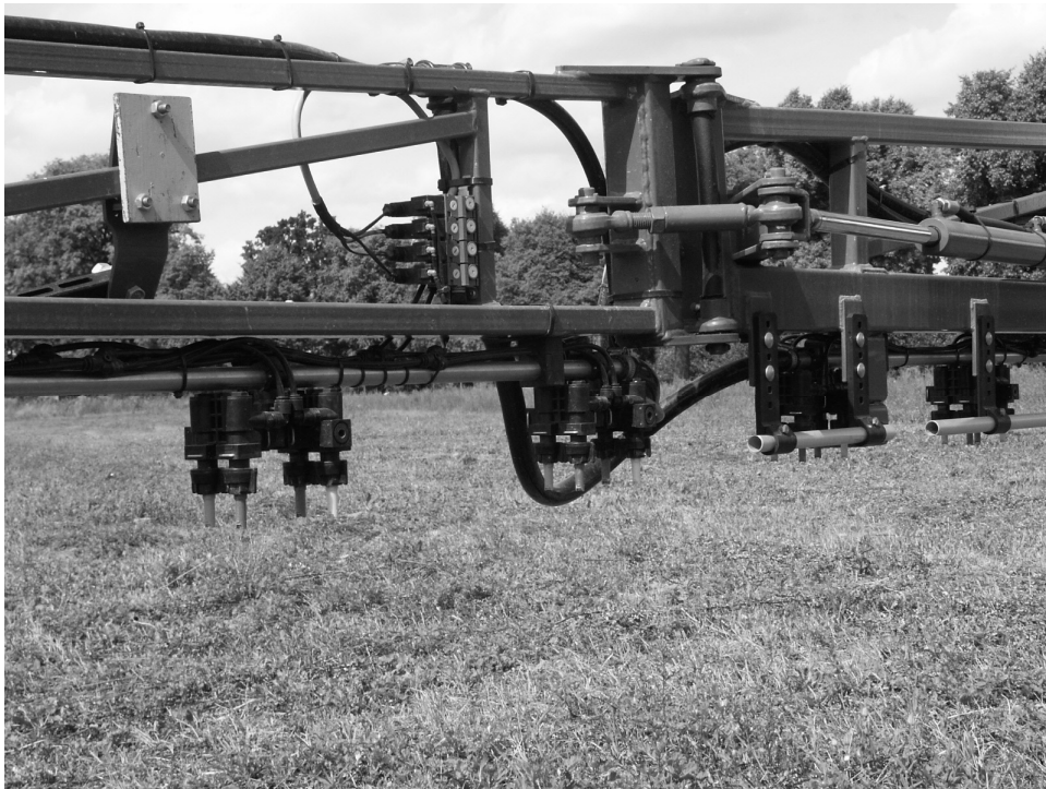
Bild 15: Spritzbalken mit den Mehrfach-Düsenträgern
