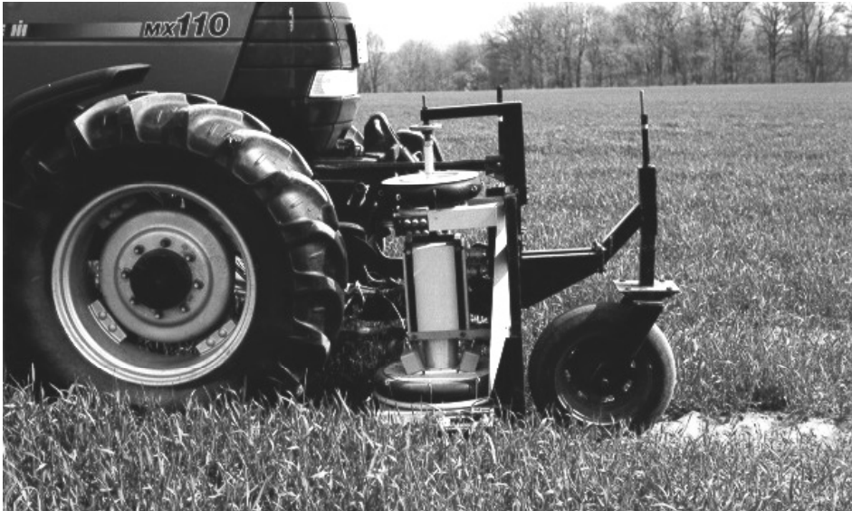
Bild 6: Prinzipmuster Diodensensor im Feldeinsatz
