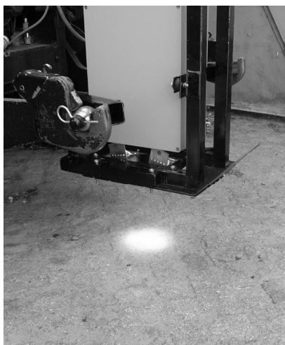
Bild 50: Beleuchtungseinrichtung, Lichtkegel fokussiert
