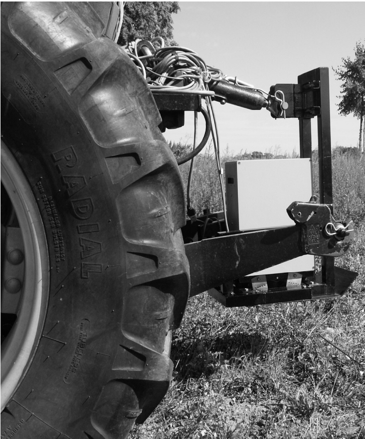
Bild 48: Seitenansicht der mittigen Sensorführung
