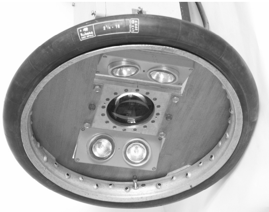
Bild 8: Halogenlampen zur Ausleuchtung der Detektionsfläche
