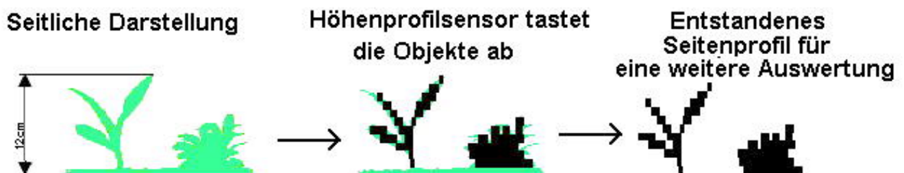
Abb. 3: Schematische Darstellung eines Seitenprofils mit dem Höhenprofilsensor Fig. 3: Schematic structure of scanfunction from the Heigh-profile-detector
